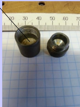
Капсула с мишенным веществом после нагрева
