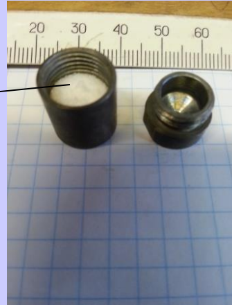
Капсула с мишенным веществом до нагрева
